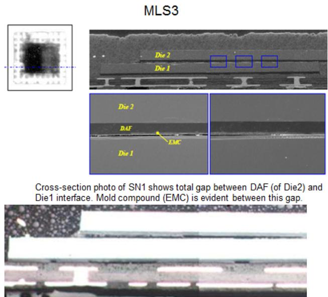
Figure6. Top die delamination and Bottom die voids
